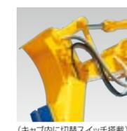
作業時の誤操作防止として、バケットシリンダ閉じ操作を無効にします。ハーベスタがキャブに近づき過ぎることを防ぎ、安全に作業することが可能です。
