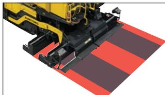
下層用ホッパーから改質アスファルト混合物が、わだち発生部に供給されます。上層用ホッパーからその他の部分に普通アスファルト混合物が供給され、同時に帯状に敷きならされます。
