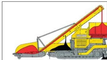
マルチアスファルトペーバは下層用、上層用の2つのホッパーを持ち、チャージャによりアスファルト混合物を各ホッパーに供給します。下層を下層スクリーンで敷きならした後、直ちに上層スクリーンで上層を重ねて敷きならします。
