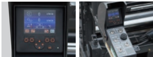
スクリーン操作ボックスのカラーサブモニター
