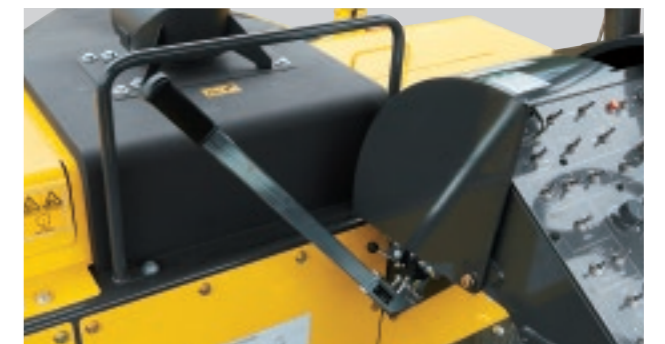
シリンダ手動操作が可能なハンドポンプ(オプション)
