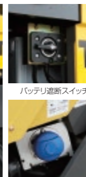
バッテリー遮断スイッチ 尿素給水口
