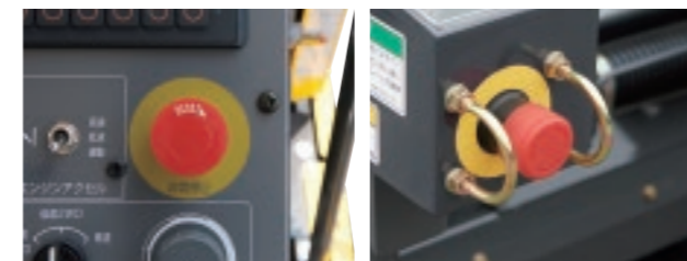
*非常停止スイッチ作動時にはモニター表示されます。
