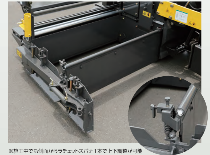
※施工中でも側面からラチェットスパナ1本で上下調整が可能
