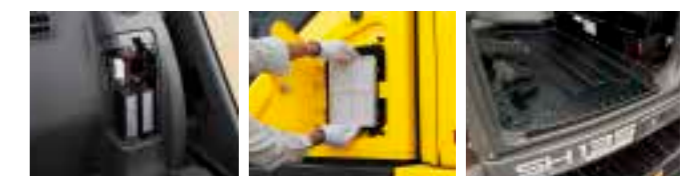
シート後方に集中配置したヒューズボックス
