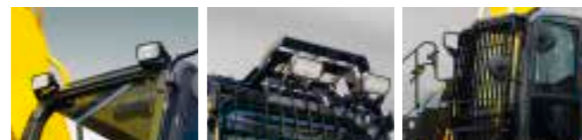
キャブ上ライト(ハロゲンタイプ) ヘッドガード(FOPSLレベル2) フロントガード(OPGレベル1) 写真のキャブ上ライトは別オプション
