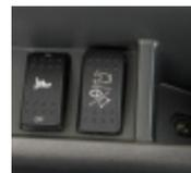
キャブ内の切替スイッチにより、フォークグラップルモードと大割圧砕機モードのセレクトをワンタッチで行うことが可能。大割圧砕機モードをセレクトすることで基礎解体作業も行えるため、上屋解体から基礎解体まで1台で対応することができます。
