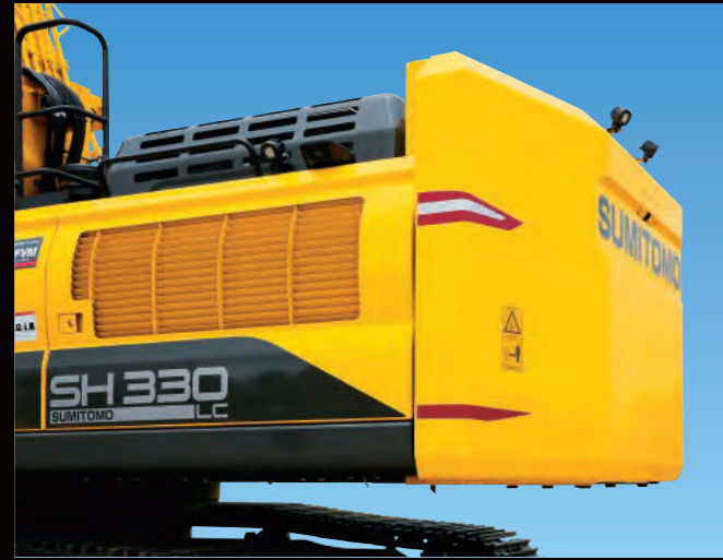
カウンタウェイトの形状を大幅に変更。旋回底面のみだしを改善し、さらなる作業安全性に貢献します。
