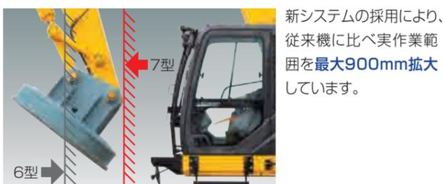
新システムの採用により、従来機に比べ実作業範囲を最大900mm拡大しています。
