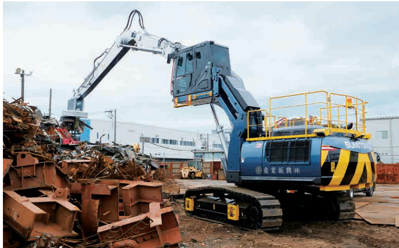
SH330LC-7MH マテリアルハンドリング仕様
