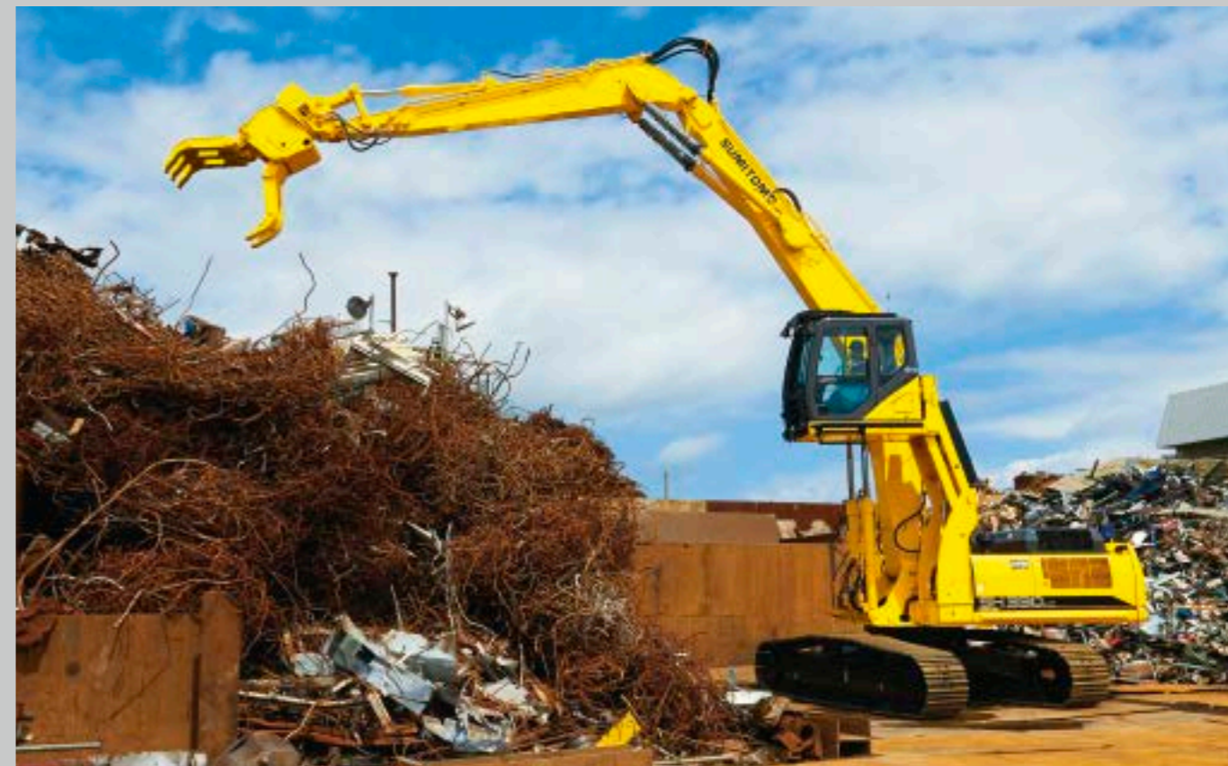
SH330LC-MH マテリアルハンドリング仕様
