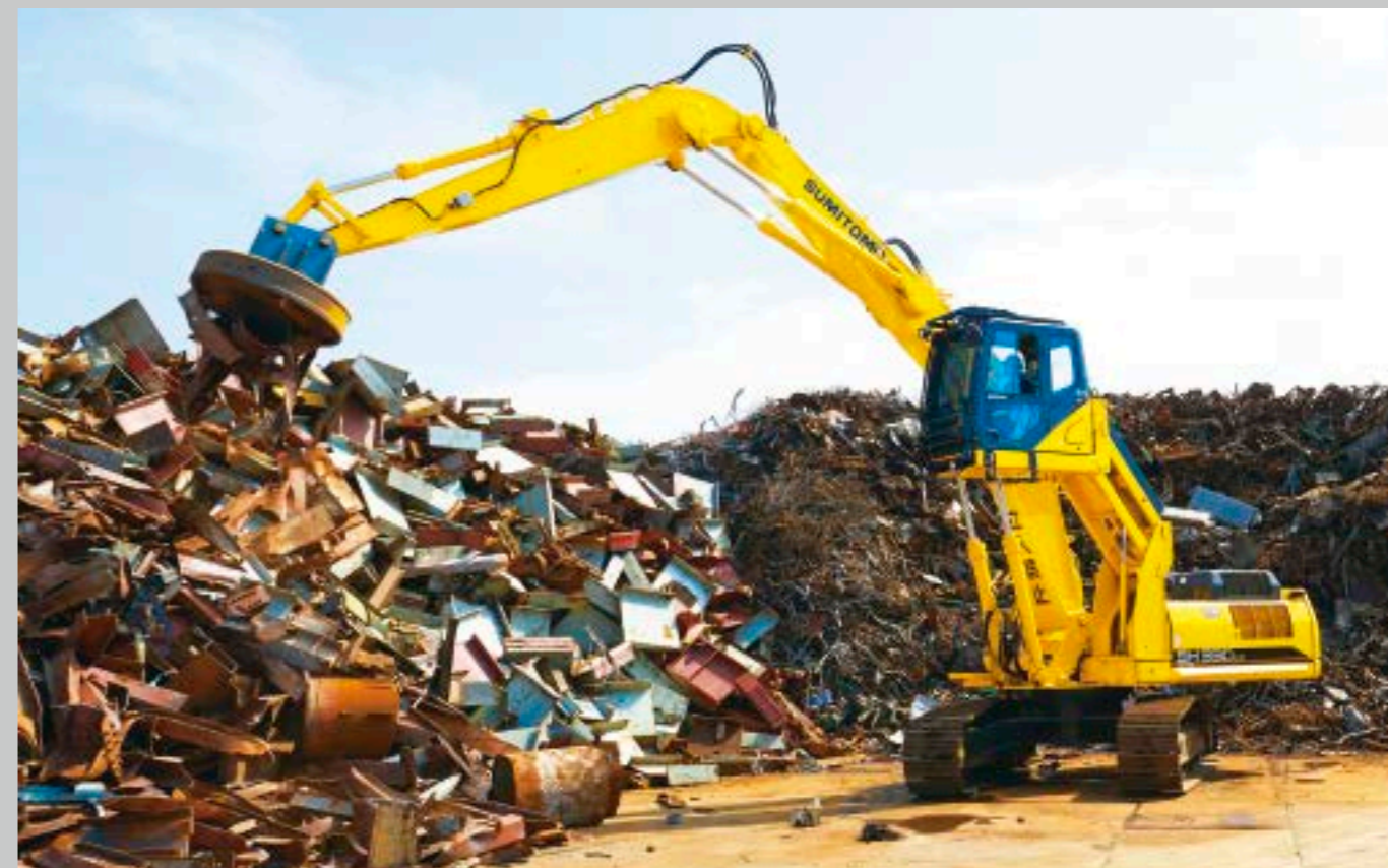
SH330LC-MH マテリアルハンドリング仕様
