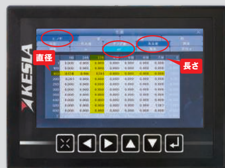
データ画面 (生産) 樹種、用途、体積 (直径・長さ) などの生産データを一覧表示することが可能です。
