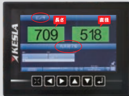
基本画面(設定長さで停止/緑) あらかじめ設定した長さをわかりやすく表示。右側の数値は木の直径を、左側の数値は木の長さを表しています。
