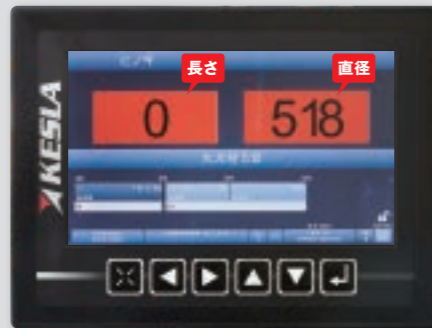
基本画面(切断後/赤) 数値を示す画面が赤に変わり、切断が完了したことを知らせます。切断後であることから、長さの数値は0になります。
