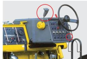
走行レバー及び自動・手動切換スイッチ/作業・走行スイッチ停止がONの時は、エンジンは始動しないシステムになっています。
