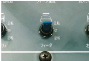
路盤材がコンベヤに噛み込んだ時は、スイッチ操作によりコンベヤを逆転して外せます。
