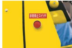
本機は、エンジンを緊急停止する非常停止スイッチを本体左右2ヶ所に設け、安全性を向上しています。
