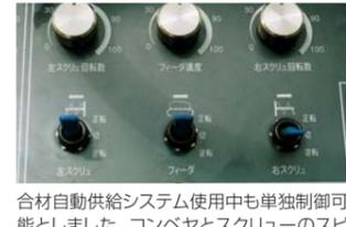
合材自動供給システム使用中も単独制御可能となりました。コンベヤとスクリュウのスピードコントロールは電磁比例(可変)式とし、作業に最適な搬送量と横送り量が得られます。またスクリュウは左右単独・正逆回転操作も可能です。
