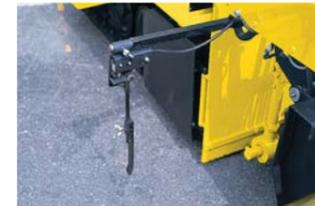
スクリュウより左右に送られる合材量をフレーム後部の両サイドに設けた検知センサーによりコンベヤ、スクリュウの駆動と連動し、自動制御ができます。
