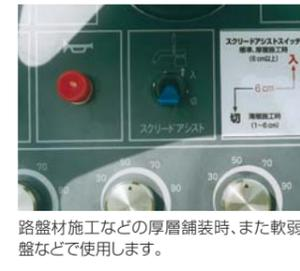
路盤材施工などの厚層舗装時、また軟弱路盤などで使用します。
