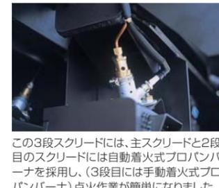
この3段スクリードには、主スクリードと2段目のスクリードには自動着火式プロパンバーナを採用し、(3段目には手動着火式プロパンバーナ)点火作業が簡単になりました。(HB1430C-5B)
