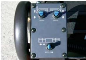
ピボット上下スイッチ、スクリード伸縮スイッチの操作がスクリード両サイドで行えます。(HB1430C-5B)
