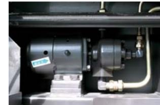
締め固め装置は、油圧式バイブレータ仕様で、合材の種類による締め固めの転圧力を変換する事ができます。
