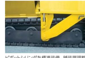
ピボットシリンダを標準装備。舗装厚調整が即座に対応でき作業性が更に向上しました。ピボット上下操作は機体両サイドから可能でオペレータのみならずレーキマンも作業状況に合わせて操作できます。
