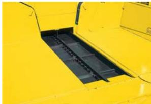
コンベヤは独自のセンターリンク方式を採用。搬送量が109m³と大きい。(実用新案取得済)
