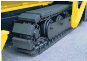
クローラは耐久性のある好評のゴムパッド付で、クラストップの牽引力で舗装路面も安心して走行でき、クローラ張調整は容易にできます。
