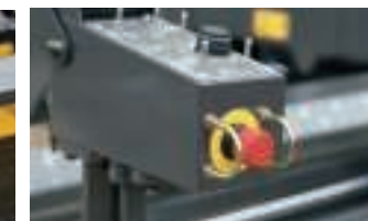
非常停止が作動した際はモニターにアイコンが表示されます。
