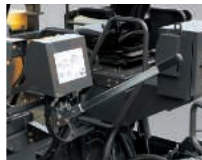
*ホッパ、スクリーンのシリンダ操作が手動で行え、輸送姿勢に対処可能です。
