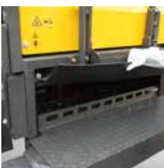
バーナ点火状況確認の容易化
