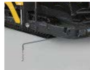
走行指針照明灯
