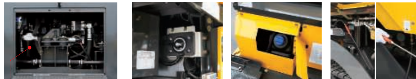
エンジンオイルフィルタ バッテリースイッチ 尿素水タンク 洗浄装置(左右)
