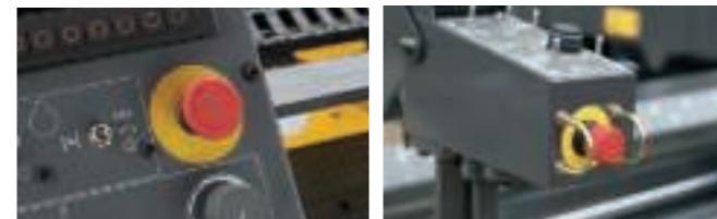
非常停止が作動した際はモニターにアイコンが表示されます。
