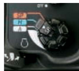
スロットル一体型モード切替機構 ボリュームを回すだけでスロットルが連動、誰でも簡単に最適な作業性能が選択できます。
