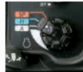
スロットル一体型モード切替機構 ボリュームを回すだけでスロットルが連動、誰でも簡単に最適な作業性能が選択できます。
