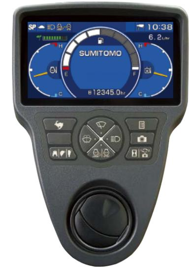
視認性の高い横型タイプのフルカラーモニターを搭載。スイッチパネルと一体化したデザインで、各種機能を集約しています。また、低燃費状態を表示するECOゲージや作業状態の表示、警告等のメッセージ表示も実現。正確な情報伝達により、作業効率や安全性を高めています。
