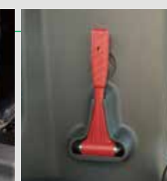
セカンダリエンジン停止スイッチ（コンソール左下）
