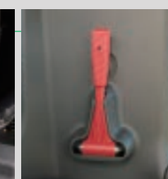
セカンダリエンジン停止スイッチ（コンソール左下）
