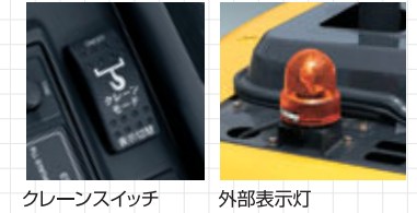
クレーンスイッチ 外部表示灯
