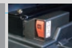
セカンダリエンジン停止スイッチ キャブ脱出用ハンマ (コンソール左下)
