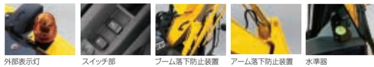
外部表示灯 スイッチ部 ブーム落下防止装置 アーム落下防止装置 水準器 (クレーン作業は水平位置で行ってください)
