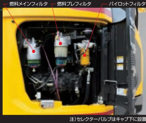
燃料メインフィルタ 燃料プレフィルタ パイロットフィルタ
