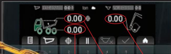
ベッセル内荷重 目標までの残荷重 バケット内荷重
