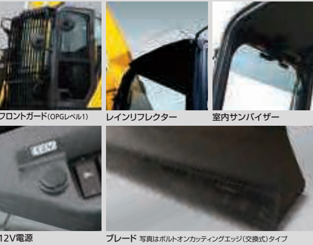
12V電源 ブレード 写真はボルトオンカッティングエッジ(交換式)タイプ
