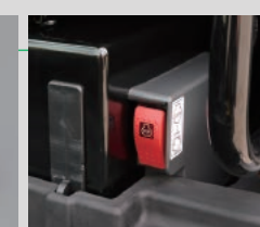
セカンダリエンジン停止スイッチ (コンソール左下)
