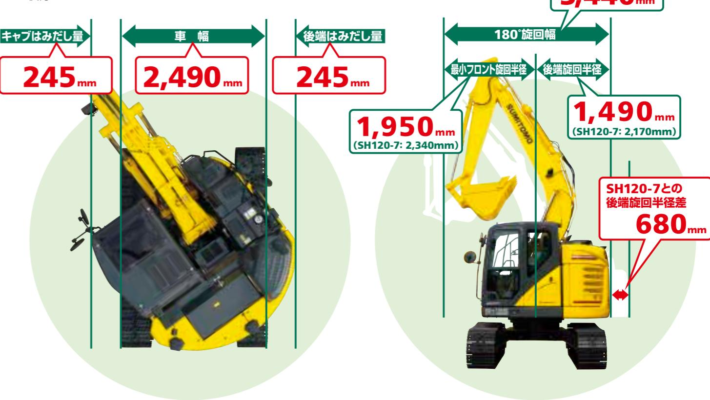
注)上記数値は標準カウンタウエイト装着時。SH135X-7の場合、増量カウンタウエイト装着時は後方超小旋回の定義から外れます。
