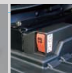
セカンダリエンジン停止スイッチ（コンソール左下）
