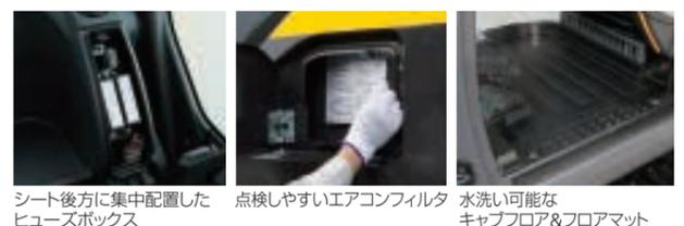
シート後方に集中配置したヒューズボックス    点検しやすいエアコンフィルタ    水洗い可能なキャブフロア&フロアマット
