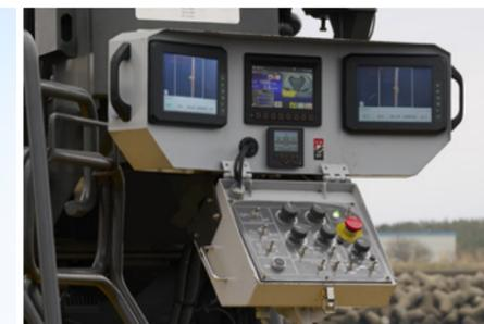
導入時に必要なのはステレオカメラと操作盤だけ。高価な3D測器や設計データを必要とせず、経済的に自動化を実現することが可能。これまでにない敷居の低さと使い勝手の良さを兼ね備え、多くの舗装工事の自動化に貢献します。
