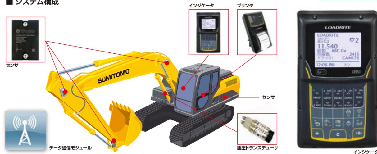
**ロードライトのポイント** 正確な計測で無駄のない積み込みが可能、レポート管理も実現!
