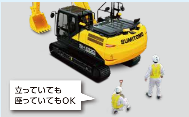
■機械そばの安全ベストを着た人を検知
