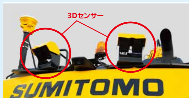
■4つの3Dセンサーで反射物だけを検知
