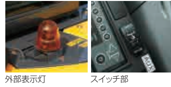
外部表示灯 スイッチ部
