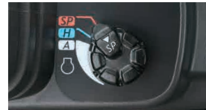
スロットル一体型モード切替機構 ボリュームを回すだけでスロットルが運動、誰でも簡単に最適な作業性能が選択できます。
