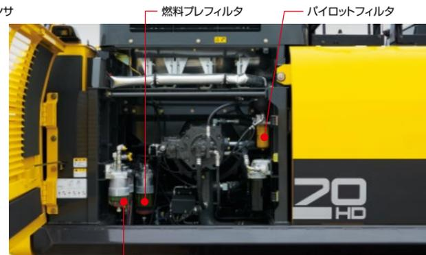
燃料プレフィルタ    パイロットフィルタ    燃料メインフィルタ
