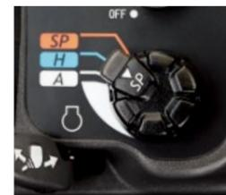
スロットルレバー型モード切替機構
