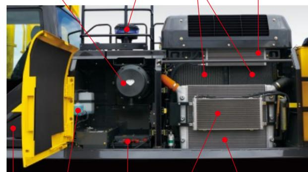
エアコン外気フィルタ    ウォッシュタンク    バッテリー    燃料クーラ    インタークーラ
