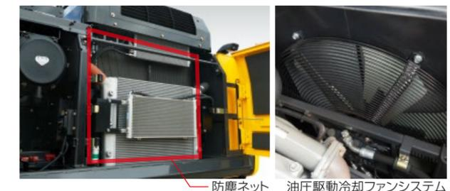
防塵ネット    油圧駆動冷却ファンシステム
