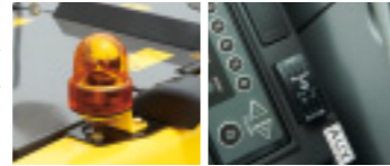
外部表示灯 スイッチ部
