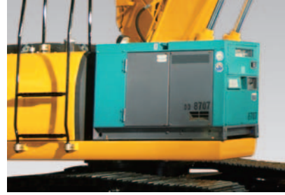
2EGLM仕様(LM用エンジン発電機搭載イメージ)
