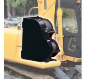
スイングヤード仕様(2胴式ウィンチ搭載イメージ)
