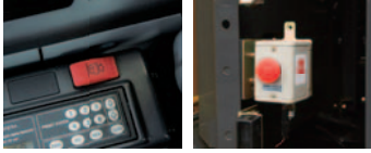
緊急降下装置(キャブ内) 緊急降下装置(キャブ外)
