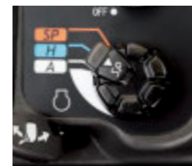
スロットルレバー型モード切替機構 ボリュームを回すだけでスロットルが運動、誰でも簡単に最適な作業モードが選択できます。
