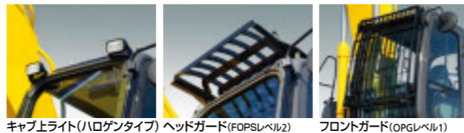
キャブ上ライト(ハロゲンタイプ) ヘッドガード(FOPSLレベル2) フロントガード(OPGレベル1)
