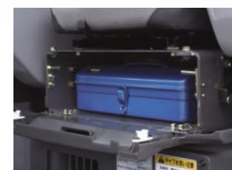
シート下に大型工具箱を設置
