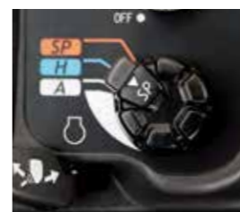
スロットルレバー型モード切替機構 ボリュームを回すだけでスロットルが運動、誰でも簡単に最適な作業モードが選択できます。
