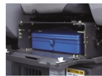
シート下に大型工具箱を設置
